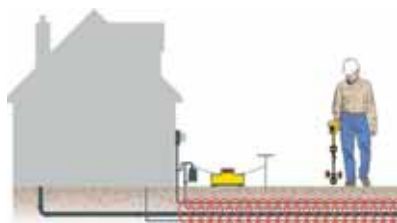
Conecte directamente con líneas de servicios públicos.
