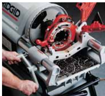
Modelo 714 (914) Cabezal de roscar de retroceso
