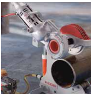
Cortatubos modelo 258 con accionamiento motorizado N° 700 durante el corte
