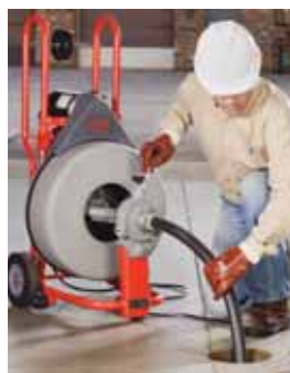
Conjunto de herramienta para tambor *Incluye acoplamiento y sujetador
