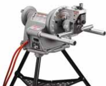
Ranuradora de rodillos 975 con accionamiento motorizado
